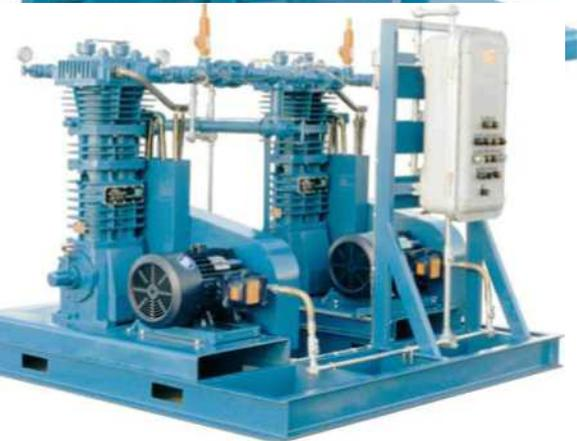
**Duplex HD613** – двухступенчатый компрессор с тройным уплотнением и панелью управления для повышения давления в системах природного газа.
