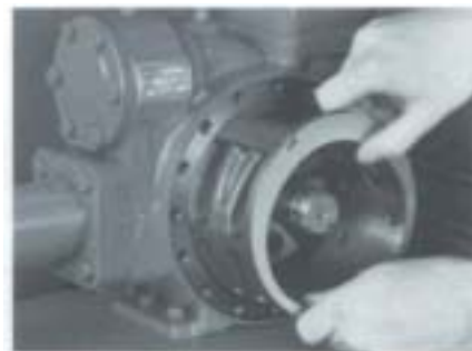
Легко заменяемая гильза восстанавливает прежнюю производительность.
