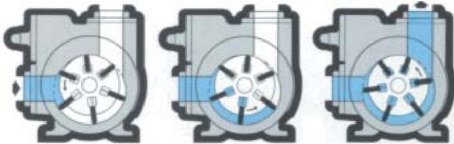
РИС. 1. Как работает пластинчатый механизм Blackmer
