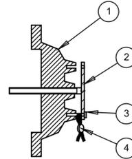
Рис.1 Схема пломбировки регулирующего лимба
