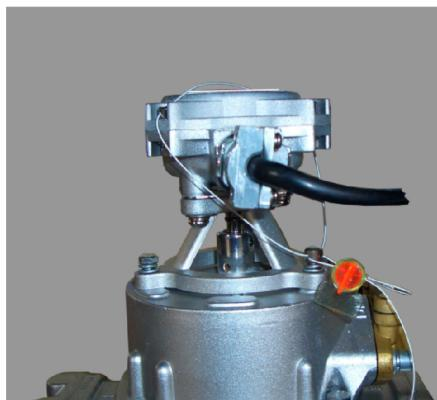
**Схема пломбировки датчика импульсов**
