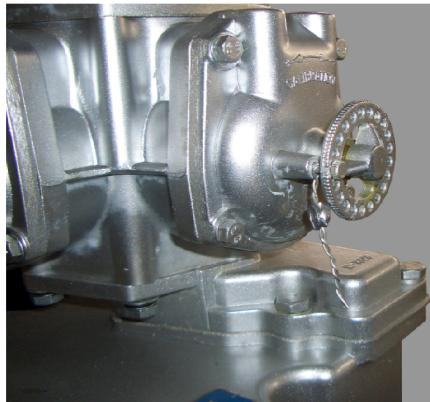
**Схема пломбировки измерителя объема**
